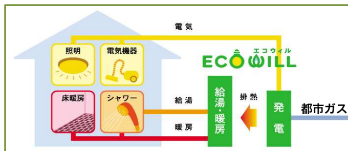
エコウィルのシステム概略図
